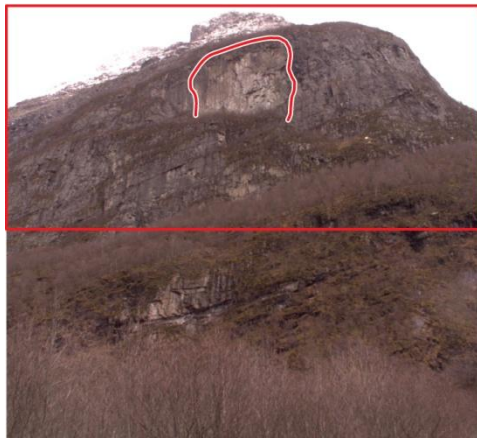
FIGUR 6 FOTO AV SVARTHAMRAN OG SKJERMBILDE FRA LASERSKANNERDATA. DEN RØDE FIRKANT PÅ BILDET VISER DET INNMÅLTE OMRÅDE OG DE RØDE LINJER VISER DET USTABILE FJELLPARTIET.
