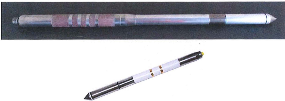
Figur 5-1: R-CPTU utstyr produsert av Geotech (øverst) og av Gouda Geo-Equipment (nederst).
