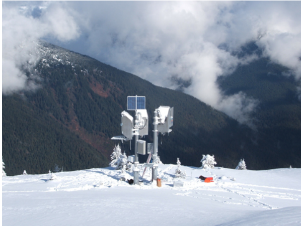
Figur 10 Avalanche Guard som står plassert på et plåtå rett over løснеområdet (SuMMit Lift Company Ltd, 2012)
