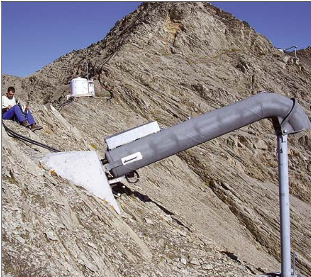
Figur 7 GasEX plassert i et løsnemråde (T.A.S, 2012)
