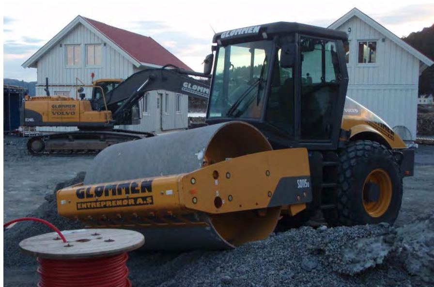
Figur 2.6 Vibrovals SD115D benyttet ved komprimering av fyllmasser (foto NVE).
