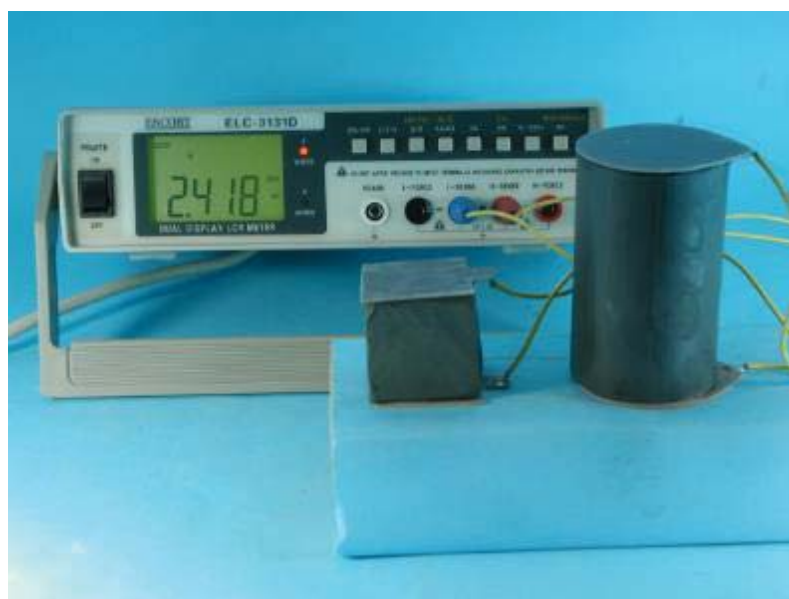
Figur 3.27 Resistivetsmåling i laboratoriet. Enkelt oppsett for måling av elektrisk motstand og elektrisk anisotropi i en prøve.
