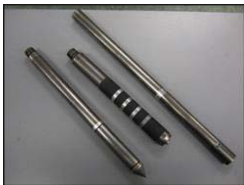
a) Geotech CPTU sonde med resistivitetsmodul
