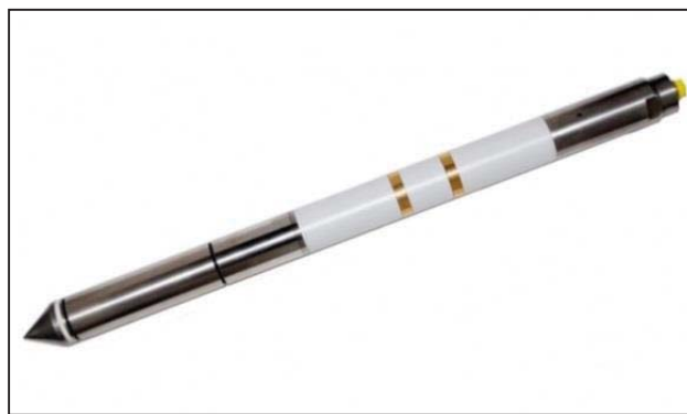
b) Montert sonde med resistivitetsmodul, Gouda
