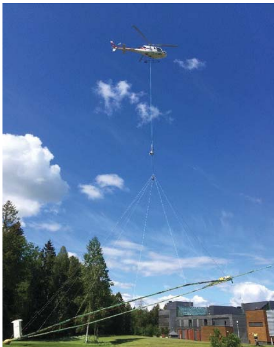
Figur 2.11: AEM utstyr (SkyTEM304), take-off ved campus for Høyskolen i Vestfold.
