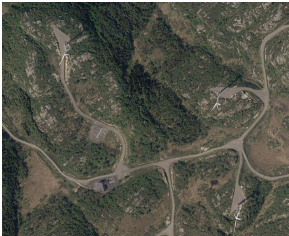
Figur 10: Satellittbilde fra Lista vindkraftverk, med vindturbiner, veier og oppstillingsplasser. ©kartverket/norgeskart.no
