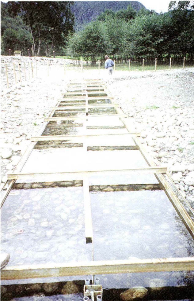
Forsøksrenne i Suldalslågen, september 1991. I den venstre siden av forsøksrenna ble det tilsatt korn, mens den høyre siden fungerte som kontroll (foto: Jon Arne Eie).
