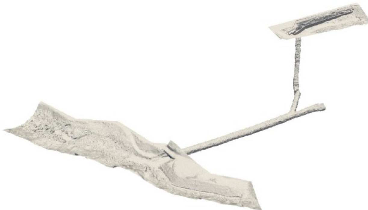
Figur 7-9: 3D-modell fra laserscan som dekker overløp, sidekanal, sjakt tunnel og utløp (Lillberg, 2021)
