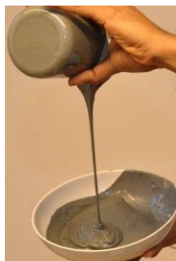
Figur 7: Omrørt kvikkleire ( c_{ur} = 0.1 kPa) [kilde: Henriette E Busterud, (Vegen og vi)]
