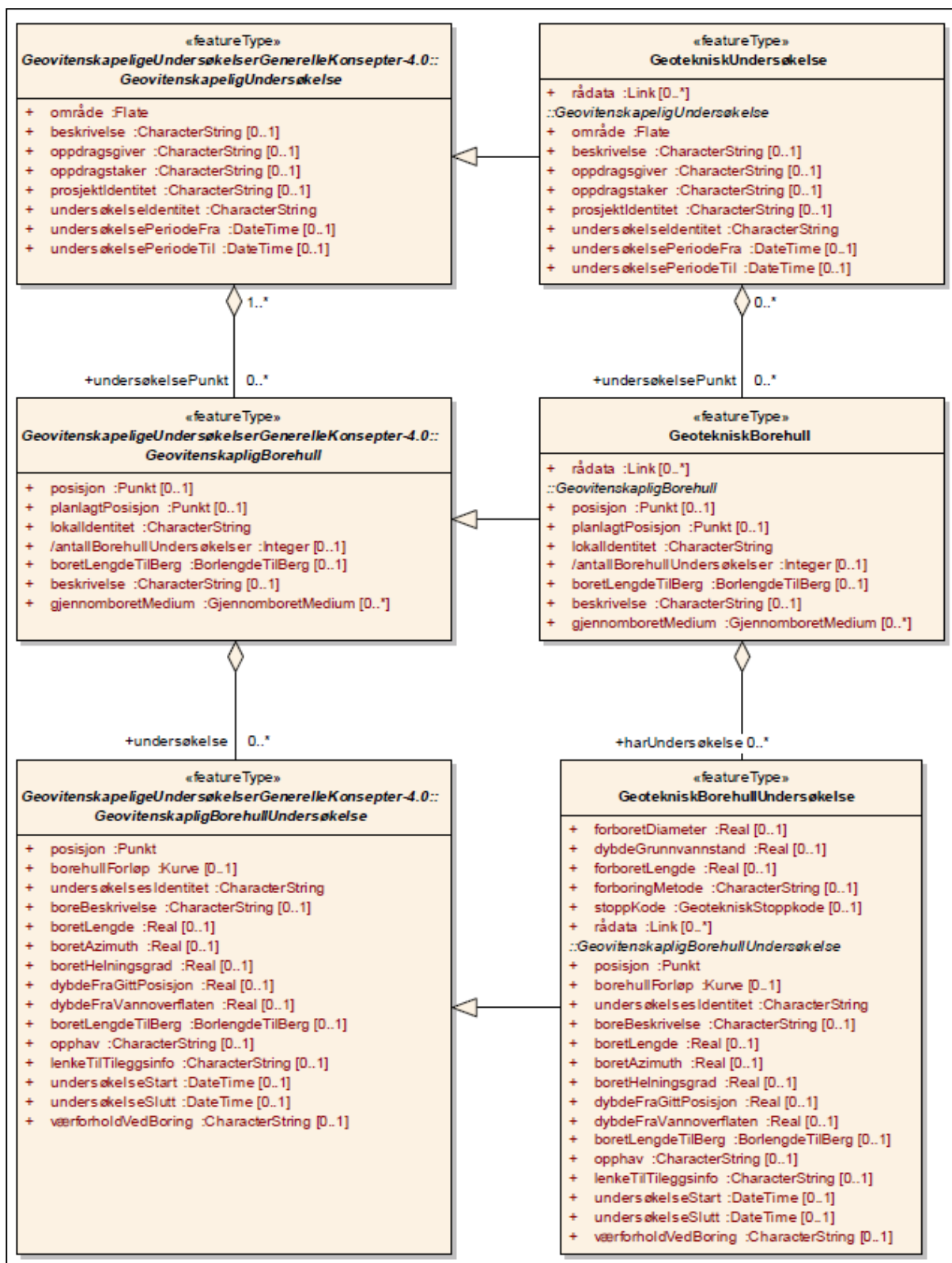
Figur 17. Utsnitt av en av mange UML-modeller fra SOSI standarden vedrørende Geovitenskapelige og Geotekniske undersøkelser hentet fra øverste nivå i datamodellen (Statens kartverk 2011b). Figuren viser hvordan objekttypene Geotekniske undersøkelser og Geotekniske borehull arver egenskaper fra de overordnede Geovitenskapelige objekttypene. Kap. 6.2-6.4 beskriver en del av konseptene bak.
