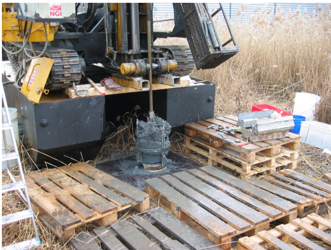
Bilde 8 Blokkprøvetakeren i bruk
