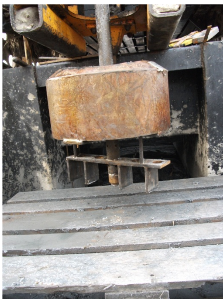
Bilde 6 "Visp" for omrøring av leire i borhullet
