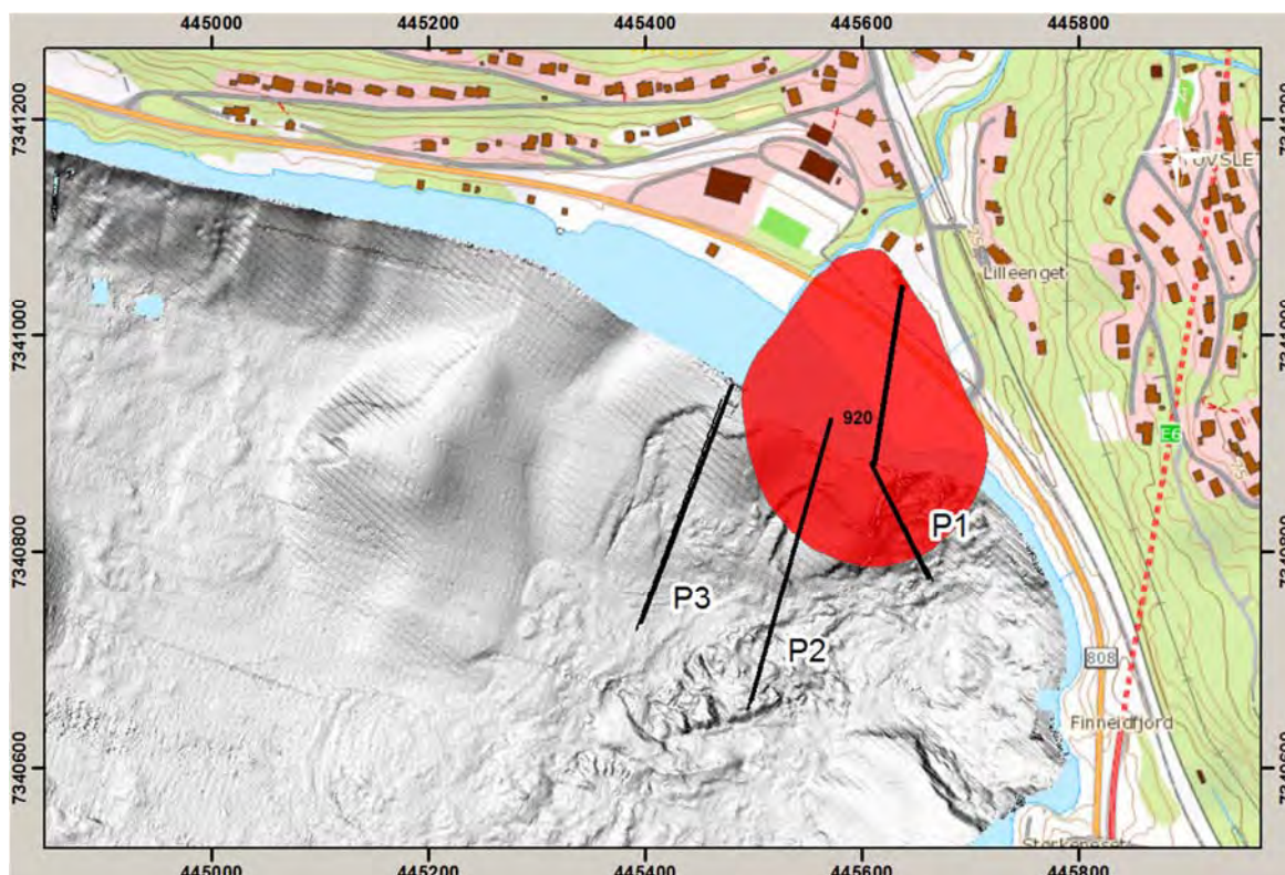
Figur B1: Detaljerte batymetriske data og skyggerelieff ved kvikkleiresonen 920-Rasteplassfyllingen ved Finneidfjord, Hemnes kommune.
