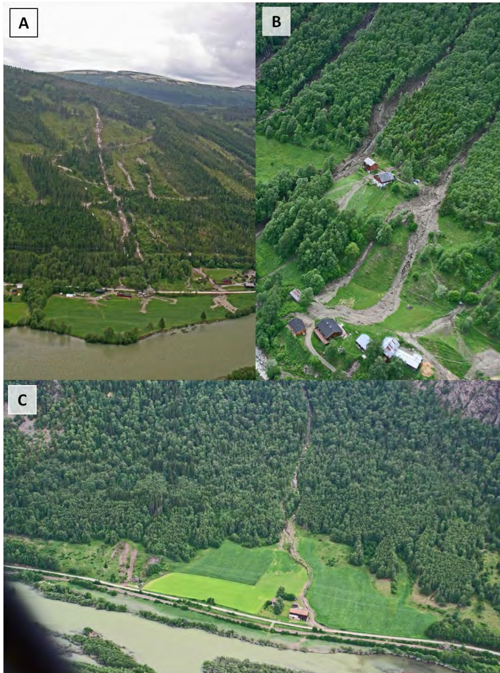
Figur 20: A) Flomskred ved Bakkelia vest for Kvam, Nord-Fron kommune. B) Flomskred mot bebyggelse i Nordlia, Veikledalen, Nord-Fron kommune. C) Flomskred ved Einangen, sør for Otta, Sel kommune. Legg også merke til flere små jordskred og utglidninger til venstre i bildet. Alle foto: A.T. Hamarsland, NVE.
