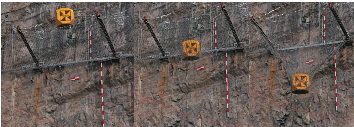
Figur 8. Fullskala testforsøk av RXE fanggjerdet i Walenstadt, Sveits (Foto: Geobrugg)
