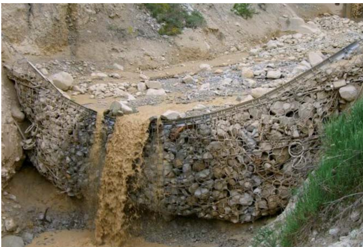
Figur 14. Her har et fleksibelt ringnett – gjerde blitt testet ut av et naturlig flomskred i Illgraben. Skredet var så stort at det strømmet over gjerdet (overtopping). Gjerdet fanget opp ca.1000 kubikk (Foto: Geobrugg)
