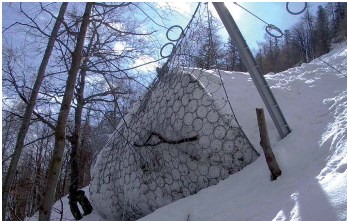
Figur 22. Her har et fanggjerd blitt fylt opp av snømasser i et testområde i Fieberbrunn i Østerrike. Legg merke til fleksibiliteten i gjerdene (Foto: Geobrugg)
