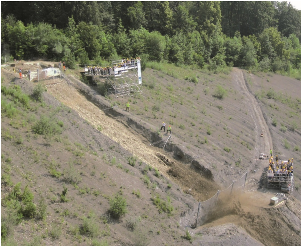
Figur 21. Fullskala testforsøk av fanggjerd for jordskred (Foto: Geobrugg)
