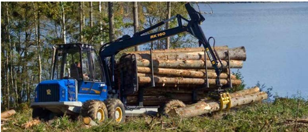
Figur 3.5. Lastbærer. Kjører tømmer fram til bilveg. Kilde: skogteknikk.no
