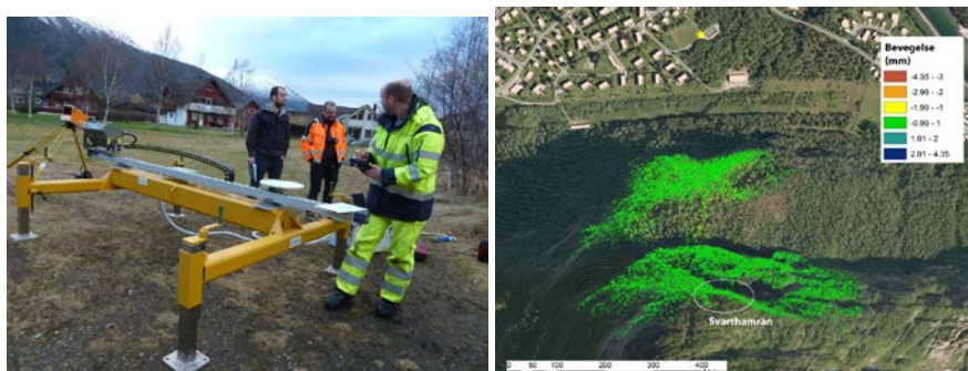
Figur 29: Venstre bilde: Bakkebasert radar på stålfundament (forgrunnen), bakkebasert laserskanner på trefot (bakgrunnen til venstre). Høyre bilde: Radardata projisert på terrengmodell. Foto hentet fra [135].
