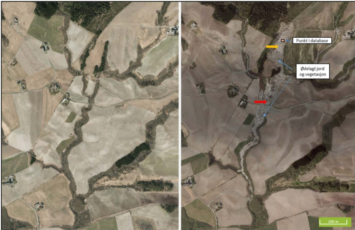
Figur 6. Ortofoto fra Esp i Sør-Trøndelag (fra norgebilder.no ). Bildet til venstre ble tatt den 01.05.2011. Bilde til høyre ble tatt den 22.05.2012, dvs. fem måneder etter kvikkleireskredhendelsen (01.01.2012). Skredmassene har vært transportert ca. 1200 m langs bekken, og disse massene (markert med rød pil) har litt mørkere grå farge enn den tømte skredgropa (lysere grå farge markert med oransje pil). Bredde av området som er berørt av hendelsen er opp til 150 m. Oransje firkant viser hvor punkt ble digitalisert i NSDB da skredet ble registrert.
