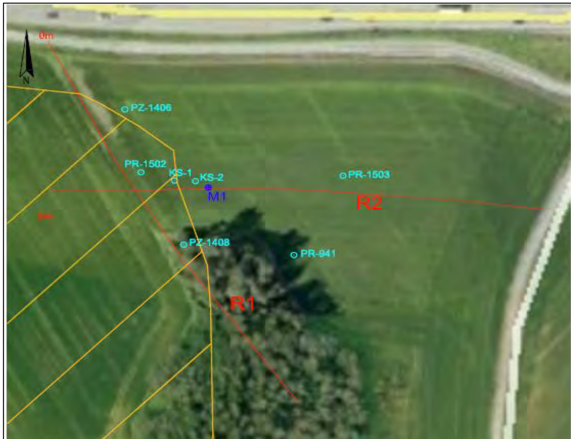
Figur 3.1 Opplegg for 2D resistivitetsmålinger på forsøksfelt Klett.
