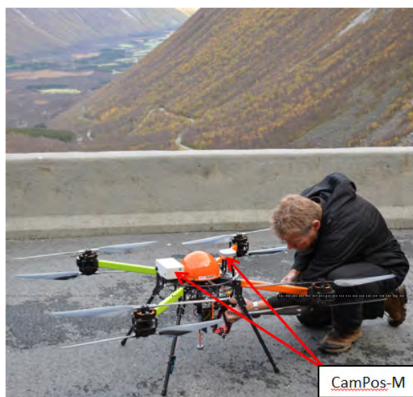
CamFlight X8 dronen med CamPos-M posisjoneringssystem (GPS/GLONASS mottaker)
