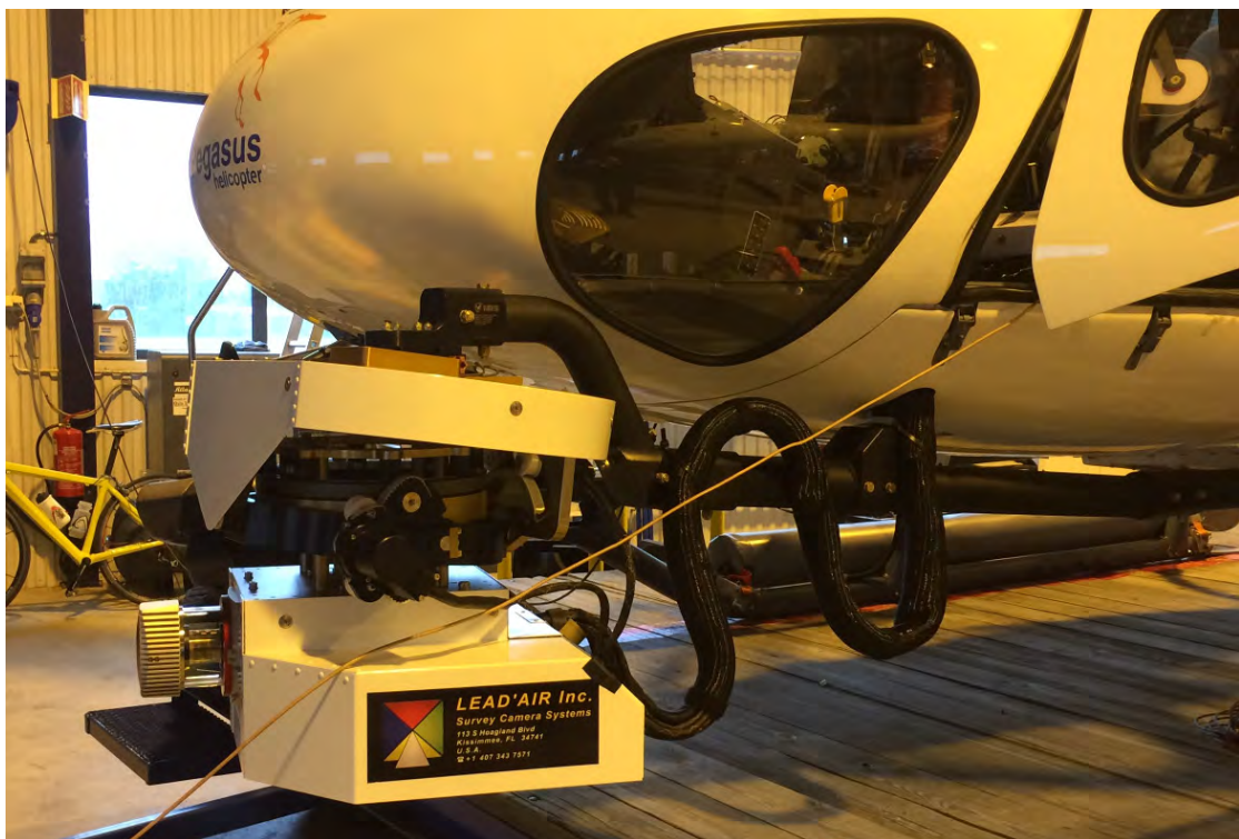
TerraTec sitt VUX-1/kamera system under monteringen på helikopteret.
