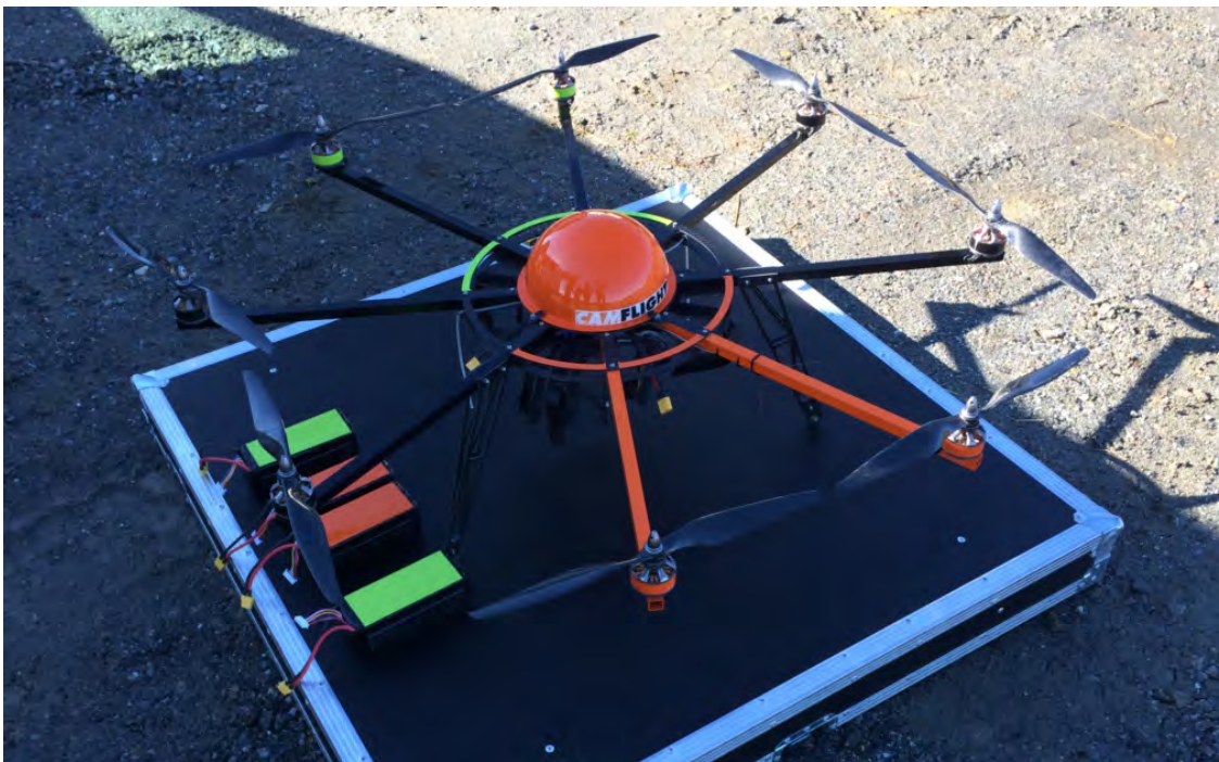
CamFlight 8 dronen. Denne har 8 armer med hver sin rotor, mens CamFlight X8 har 4 armer med doble rotor.
