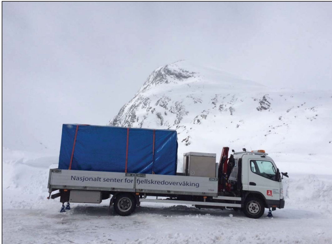
Figur 3: Radaren var plassert på lasteplanet av ein lastebil, dekkja av eit telt. Stavbrekka er i bakgrunnen.
