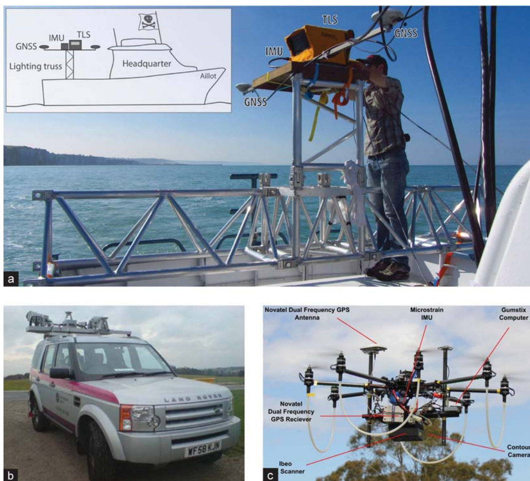
Figur 11: Bilder av ulike løsninger for mobil laserskanning: a) fra båt (fra Michoud m.fl. 2015); b) fra taket av en bil (fra Sampson m.fl. 2012); fra en drone (fra Wallace m.fl. 2012).
