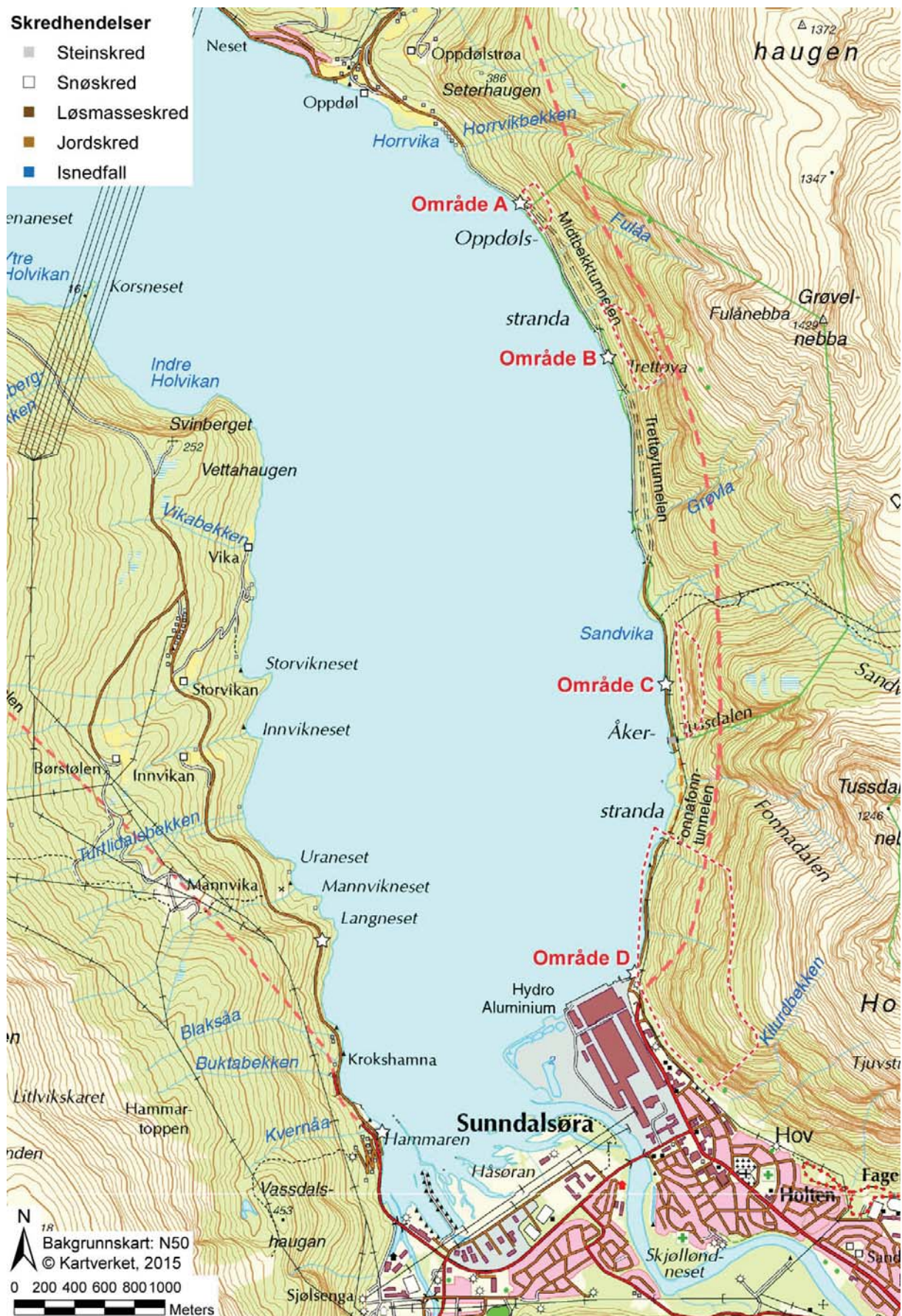
Figur 32: Kart over testområdet Oppdølstranda: den skredutsatte veistrekningen er inndelt i fire områder A, B, C og D (røde stiplede linjer). Seks plasseringer av bakkebasert laserskanner er vist med hvite stjerner. Historiske skredhendelser fra den nasjonale skredhendelsesdatabasen er vist med ulike punktsymboler for forskjellige skredtyper.
