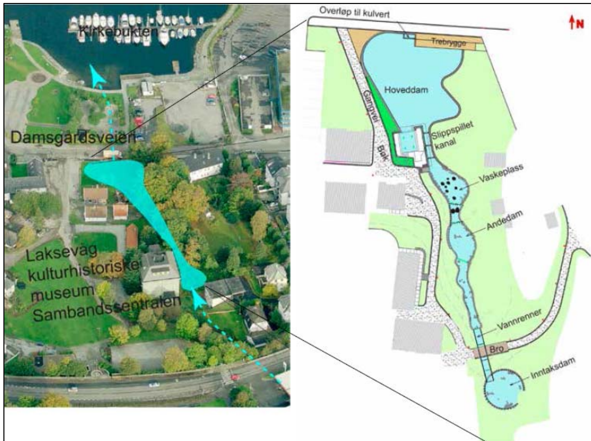
Figur 46 Illustrasjon av planane for opa drenering (Kveim, 2014).
