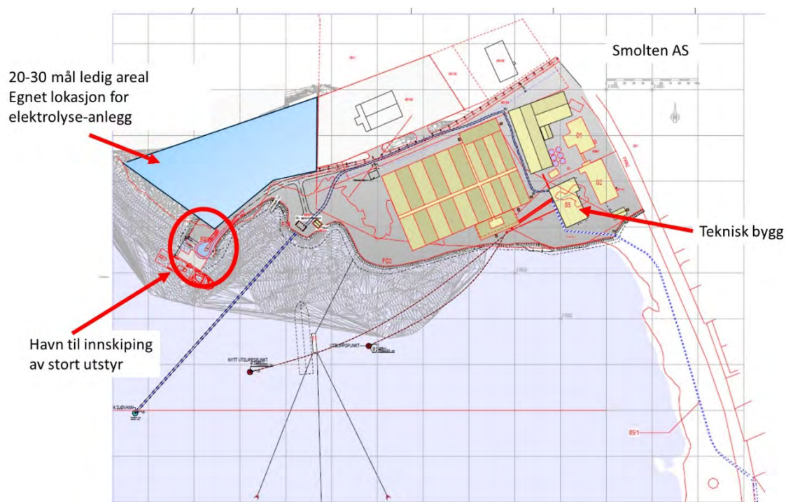
Figur 8 Plassering av elektrolyseanlegget og innskipping av stort utstyr ved Smolten AS på Innhavet (Kilde: Smolten AS; Welde, 2017).
