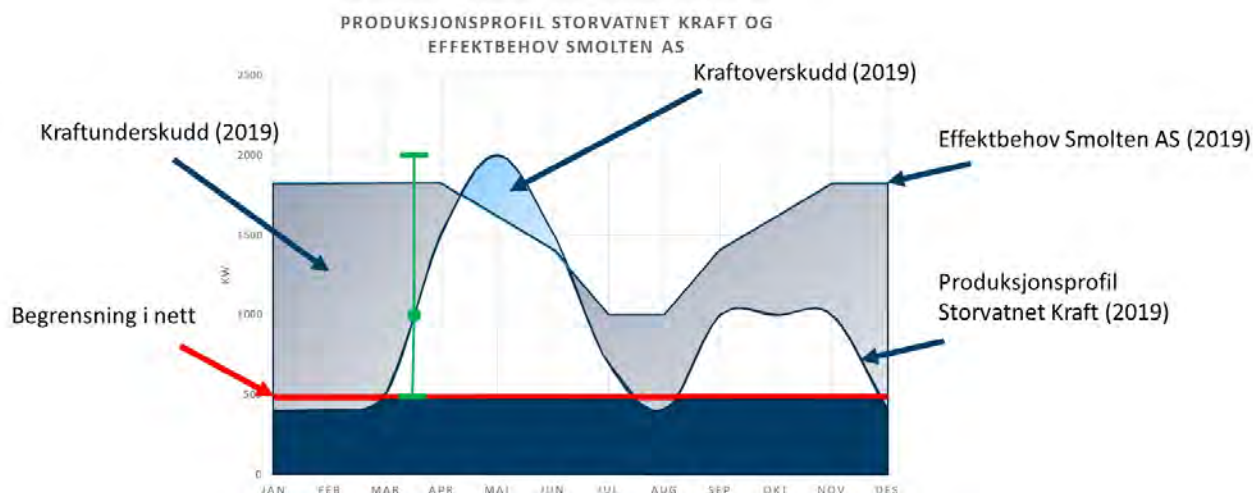
Figur 6 Produksjonsprofil ved Storvatnet kraftverk og effektbehov hos Smolten AS.
