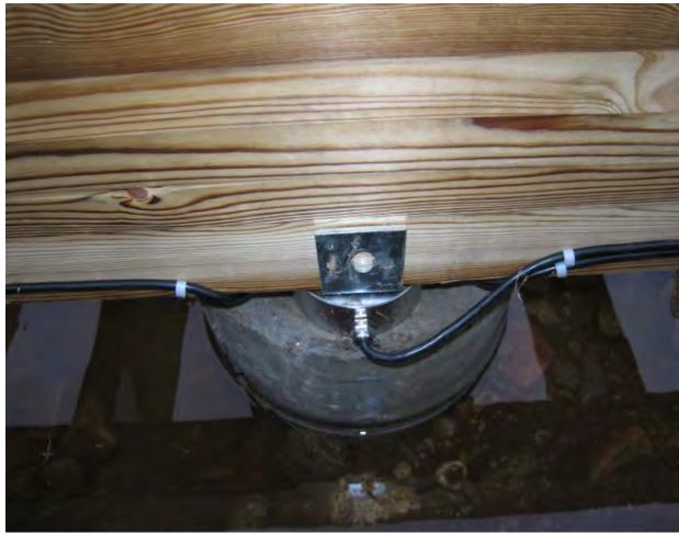
Figur 49 (t.h.) viser prinsippskisse av veiecelle (t.v.) oppsettet av betongfundament-veiecelle-stålplate-trebjelke (hoved-drager) slik det var på Anestølen sesongen 2012/2013. Foto og illustrasjon: Knut Møen, NVE
