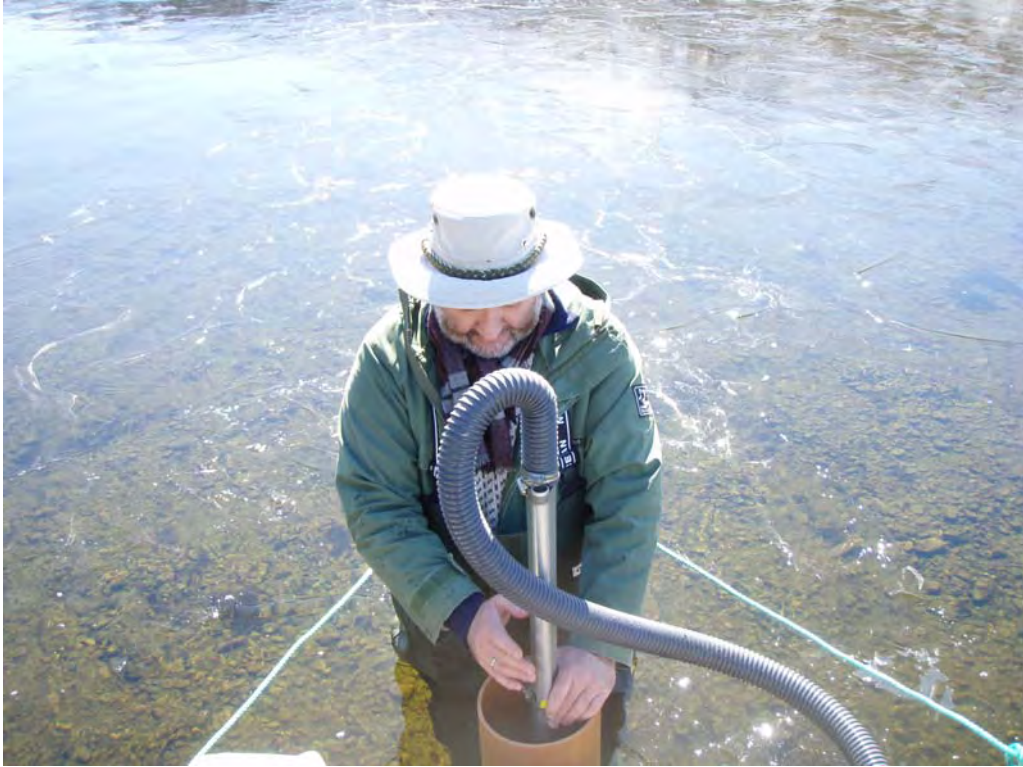
Figur 3. Prøvetaking terskelbassenget på Ekse. Én person tar prøvene, mens én person betjener pumpeutstyret fra en flåte. Foto: A. Fjellheim.
