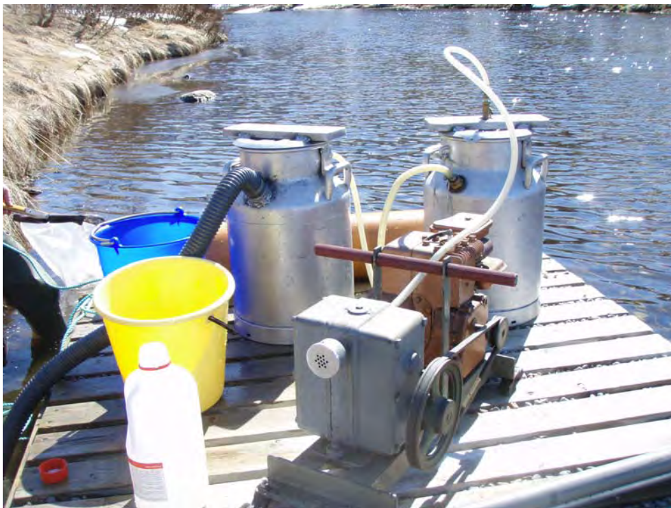
Figur 2. Sugeapparat for kvantitativ bunnprøvetaking i stilleflytende vann. For virkemåte henvises til tekst. Foto: A. Fjellheim.
