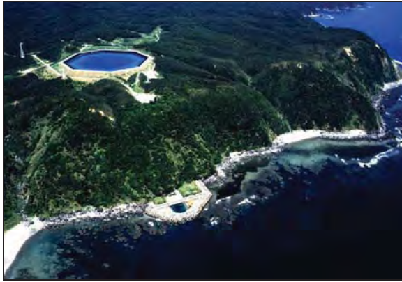
Figur 16. Pumpekraftverk i Japan som nyttar sjøvatn
