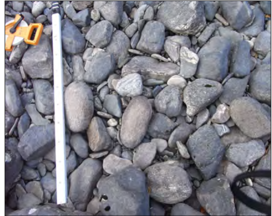
Fig. 2.24. Steintelling (Wolmans metode) ble benyttet for å bestemme kornfordelingen på deler av bankene (lokalitet 3a).
