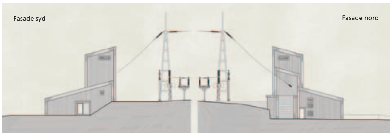
Archus arkitekters tegninger i forbindelse med anleggets utvidelse og ombygging til transformatorstasjon. Illustrasjoner: Archus arkitekter. Illustrasjonseier: Statnett SF
