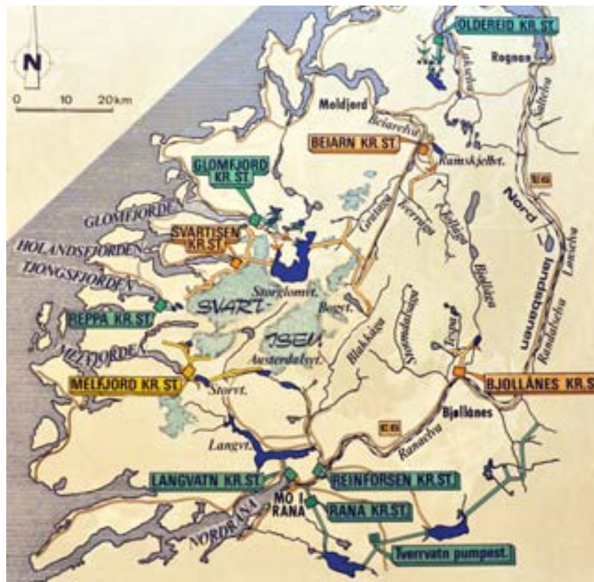
Bygging av kraftverk med mulighet for å magasinere store mengder vann har vært avgjørende for en mest mulig rasjonell utnyttelse av vannressursene i Norge. Illustrasjonen viser plan for Svartisen-utbyggingen med hovedmagasinet Storglomvatn, som er Norges største magasin med en kapasitet på 3 506 millioner kubikkmeter vann. Svartisen-utbyggingen var også helt avgjørende for byggingen av et sterkt sentralnett for kraftoverføring gjennom Nord-Norge. Illustrasjon: Statkraft
