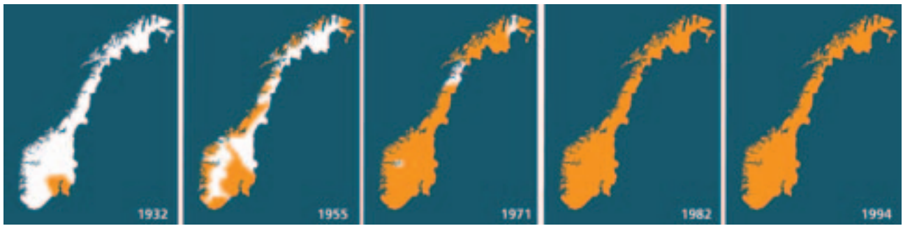
Utviklingen av samkjøringsområder i Norge i perioden 1932-1994. Illustrasjonen viser hvordan det har vært en gradvis utvikling fra enkelte isolerte samkjøringsområder til et sammenhengende nasjonalt sentralnett. I 1932 var det kun i et begrenset område på Østlandet at kraftverkene samkjørte sin produksjon. Senere fikk man en rekke regionale samkjøringsområder, og disse ble videre knyttet sammen gjennom såkalte "landsdelsforbindelser". I 1980-årene ble Norge koblet sammen til ett samkjøringsområde, men da via det svenske nettet for å knytte sammen hele Nord-Norge. I 1994, med ledningen Salten-Svartisen fikk Norge endelig et sammenhengende, innenlands sentralnett. Kart basert på illustrasjon i Skjold og Thue 2007: 1
