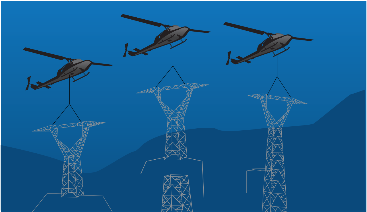
Mastemontasje med helikopter. Illustrasjonen viser trinnvis utførelse av dokkingmetoden. Illustrasjon: Rune Stubrud, NVE
