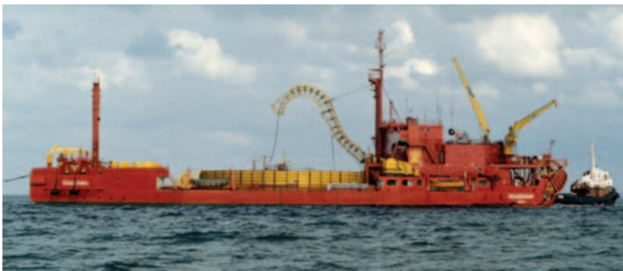
NVE–Statskraftverkens spesialskip ”C/S Skagerrak” under utleggingen av første Skagerrakforbindelse i 1976. Foto: Statnett
