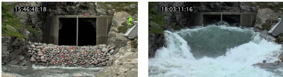
Figur 4.1: Testdammen før (v) og under en enhetsvannføring på 8 \text{m}^3/(\text{s}\cdot\text{m}) (Hiller et. al, 2015).
