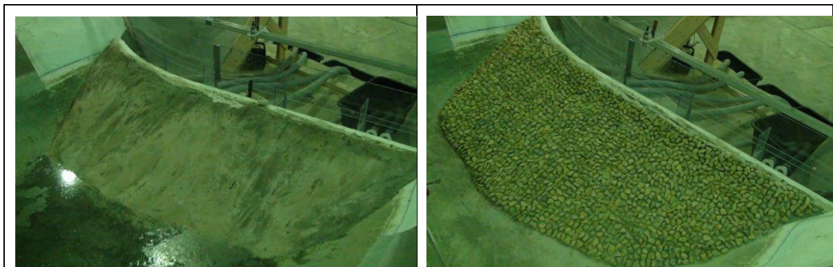
Figur 2.2: Oversikt over dammen med glatt og ru overflate i modellen (Kiflom et al. 2015)
