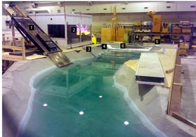
Figur 2.1: Den fysiske modellen brukt i 2014 (1: Skredrampe, 2: Kontrollrom. 3, 4, 5: Plassering av vannstandsmålere; 6: Viddalsdammen (De hvite linjene indikerer hvor dammen er plassert). (Figur fra Lorås (2014)).
