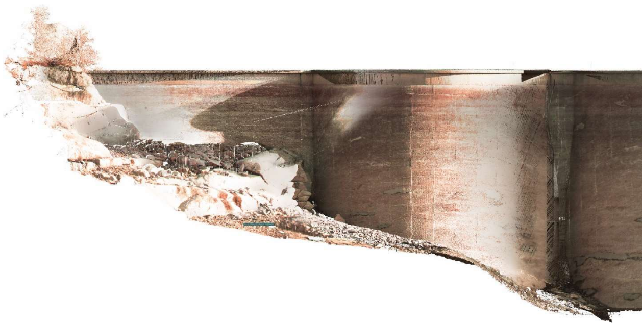
Illustrasjon 16 Vannsiden av Nåvatn III (Façade V) – laserskanning (Se Vedlegg 3)
