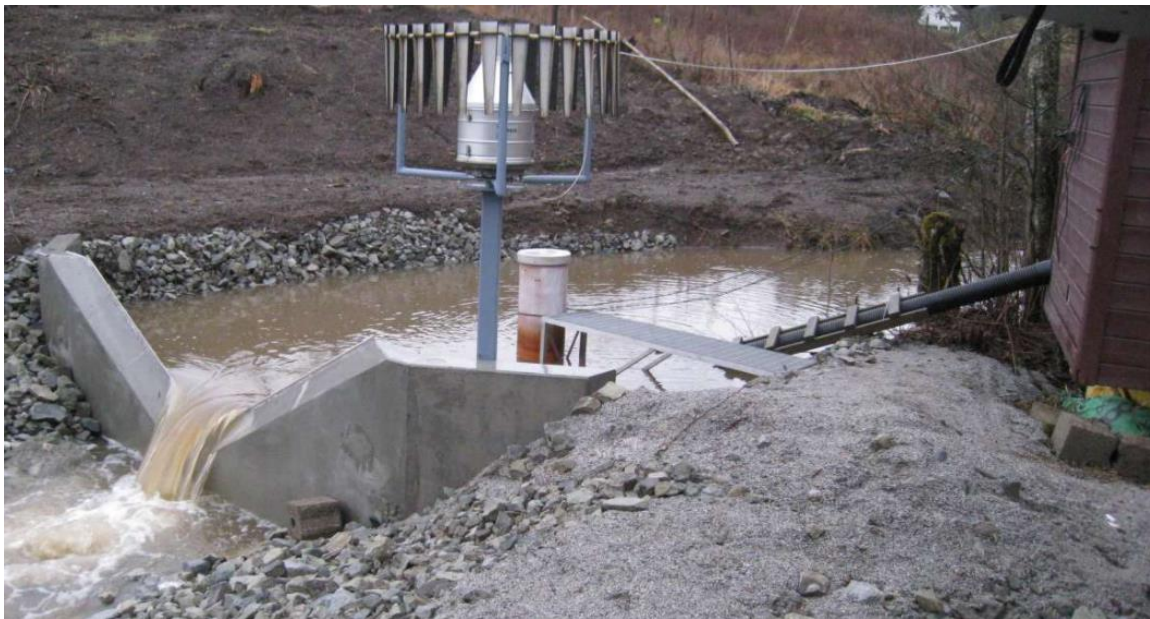
Figur 8-8. Vannføringsmåler i v-overløp i Kolstadbekken i Ringsaker. Stasjonen måler også temperatur og nedbør (Kilde: NIBIO, 2020).
