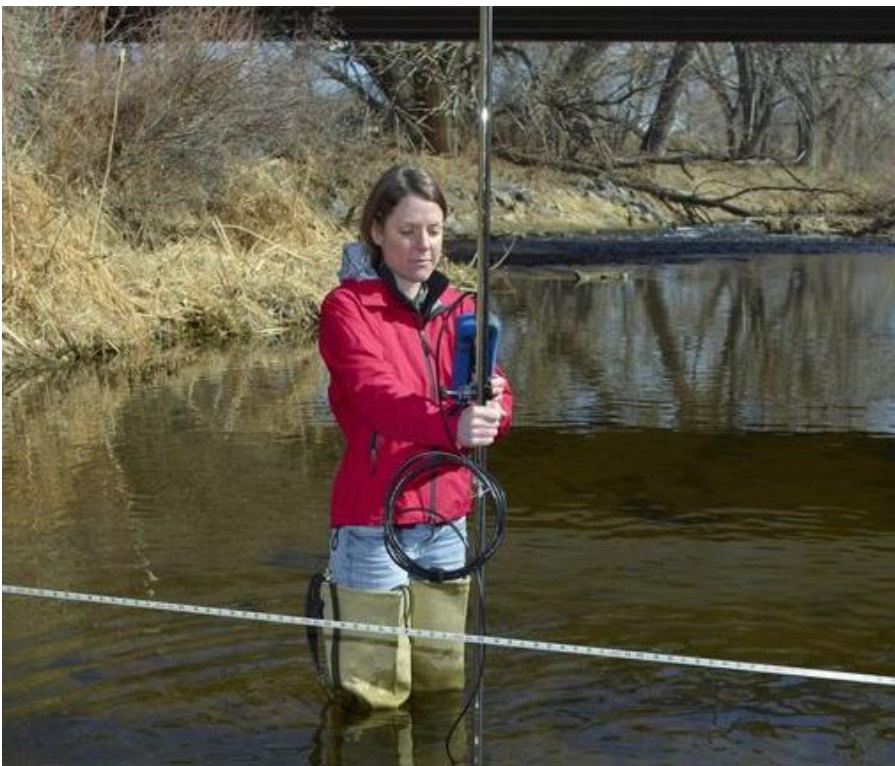
Figur 8-3. Vannføringsmåling med Flow Tracker (dopplermåler) (Kilde: www.ott.com ).
