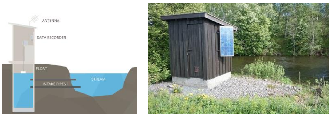
Figur 8-6. Kumstasjon. Prinsippskisse til venstre ( www.fondriest.com ) og bilde av NVEs stasjon Fossen til høyre ( www.nve.no/hydrologi ).
