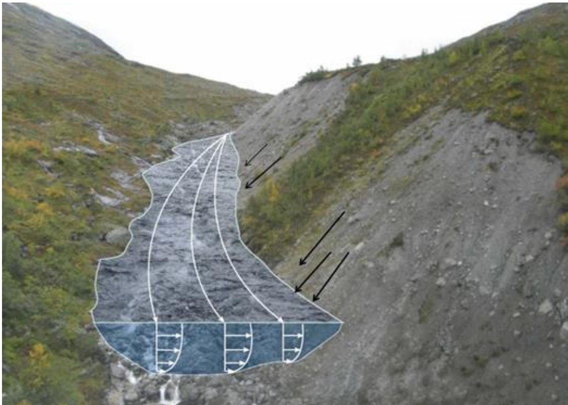
Figur 9-2. Illustrasjon av en elv som undergraver sideskråninger. Sedimenter raser ned i elveløpet og transporteres videre med vannet (Kilde: Bogen m. fl., 2016).
