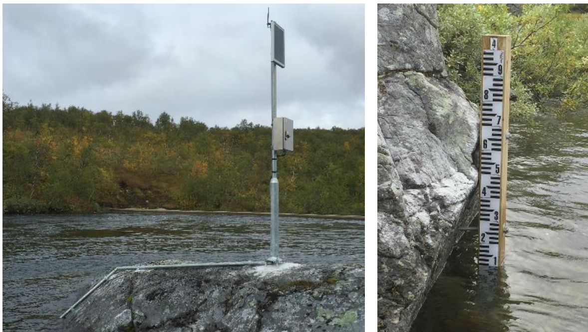
Figur 10-6. Eksempel på målestasjon for vannføring. (Kilde: www.hydrateam.no ).
